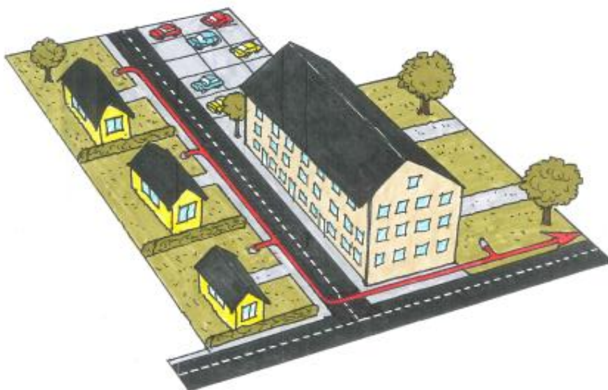
Bild 1: Bilden visar hur dagvattnet avleds i gemensam ledning (röd pil) för flera fastigheter inom detaljplan. Dagvattnet klassas därför som ett avloppsvatten enligt 9 kap. 2 § p 3 miljöbalken. Anmälningsskyldighet gäller för avloppsanordningen (ledning och/eller fördröjnings/reningsanläggning) om den avleder vattnet till mark eller recipient.
