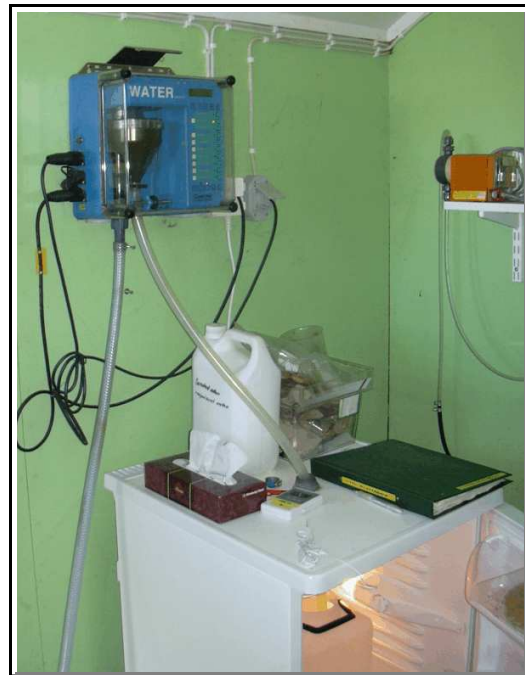
På bilden syns hur slangen från provtagaren går ner i kylskåpet och uppsamlingskärlet där. Foto L Lind
