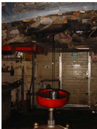
Tömning av motorolja Vid tömning av t.ex. bromsolja behöver man särskild sugutrustning
