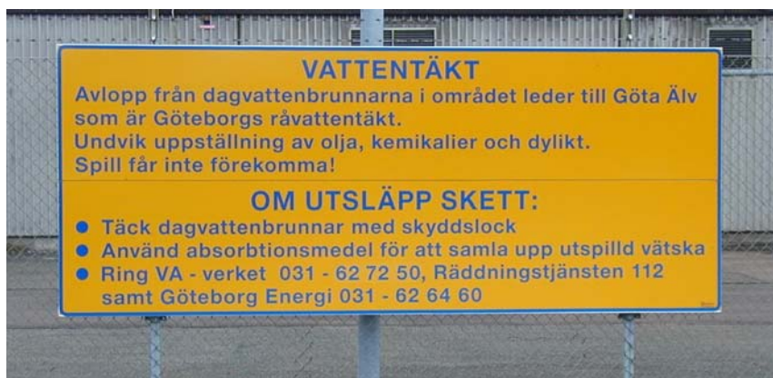
Informationsskylt om hur man ska agera vid läckage och olycka på en större miljöfarlig verksamhet i Göteborg. Foto Miljöförvaltningen i Göteborg
